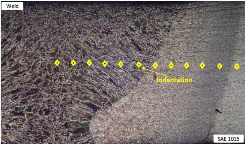
Figura 2: Estratégia do Ensaio de Microdureza Vickers
